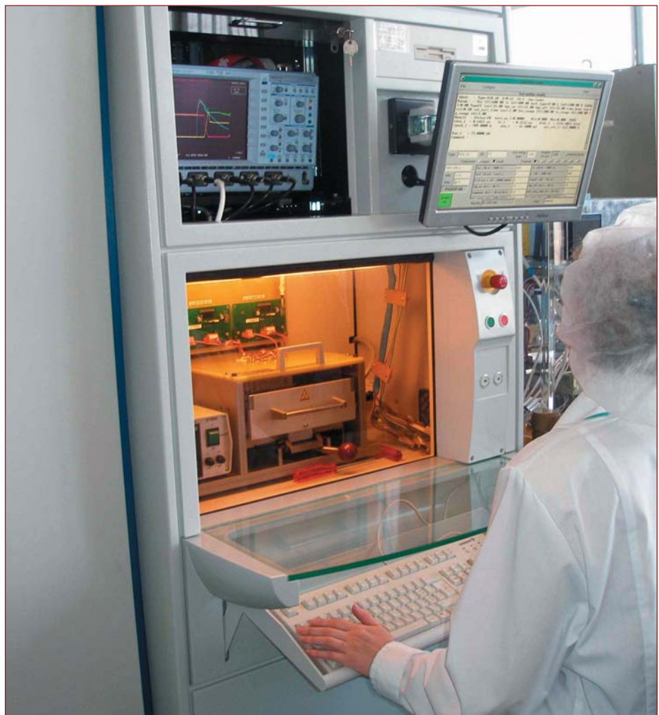
Рис. 4. Измерения динамических параметров IGBT-модулей
