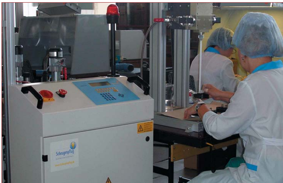
Рис. 2. Заливка модулей гелеобразным компаундом
