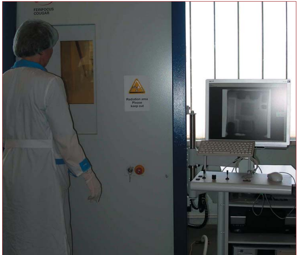
Рис. 3. Проверка качества пайки модулей на рентгеновской установке
